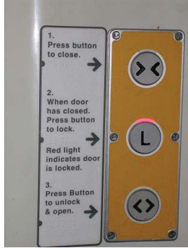
Fig. 5 Automatic Lavatory door
